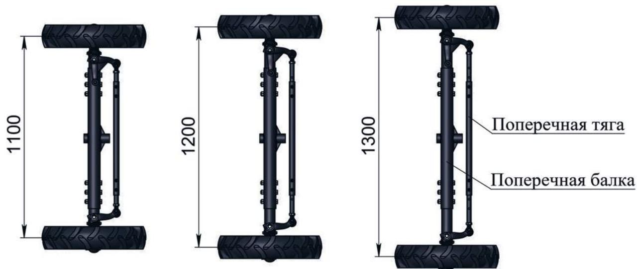
Рис. 16. Регулировка колеи передних колес.
